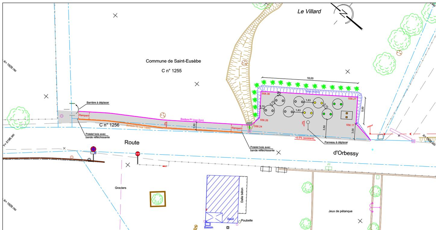
Plan d'implantation des containers semi-enterrés
